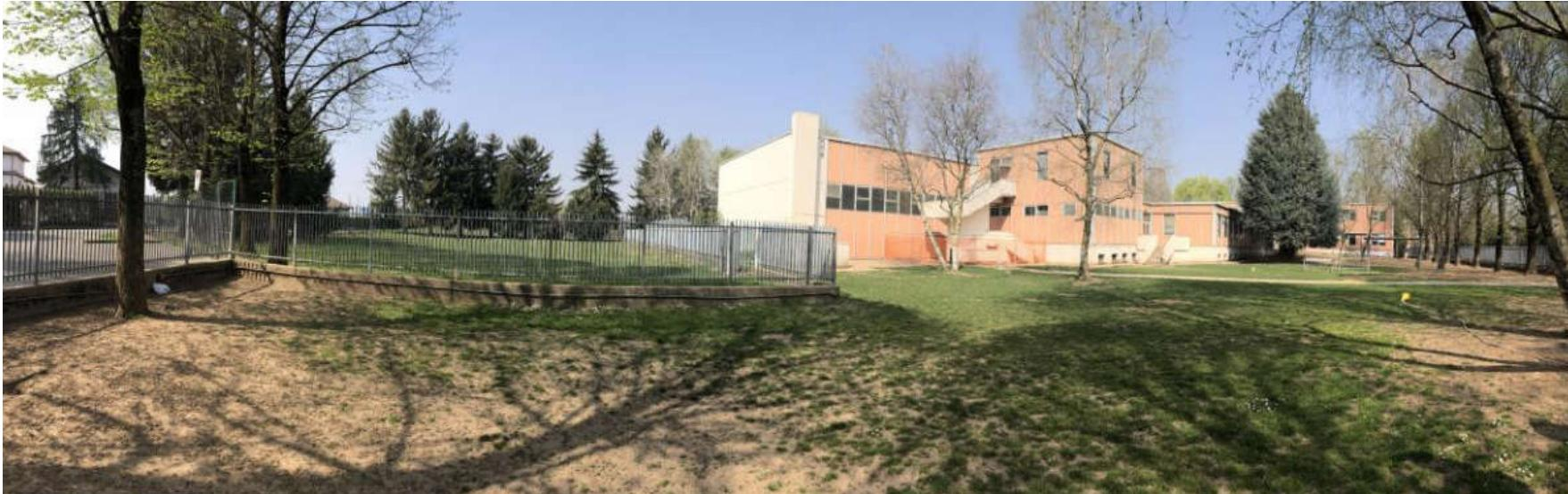
Costruito negli anni '70 su due piani fuori terra ed uno seminterrato con sistema per lo più a travi e pilastri in acciaio, tamponamenti in pannelli prefabbricati e solai in laterocemento, presenta problematiche normative, manutentive e strutturali.
